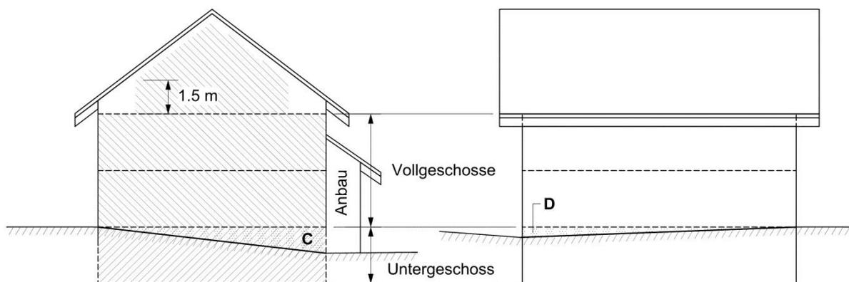
$$1.5 \text{ m} \leq \frac{\text{Fläche A + B + C + D}}{\text{Mantellinie (= totale Länge aller FL)}}$$
