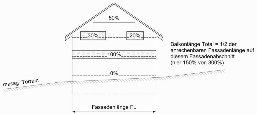
$\frac{3 \times FL}{2}$  = max. total zulässige Breite aller Balkone auf diesem Fassadenabschnitt
