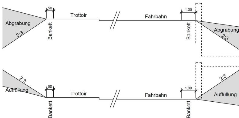
**Figur 18** Terrainauffüllungen und Abgrabungen entlang öffentlicher Strassen
